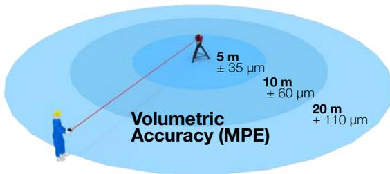
\*Measurement of a ScaleBar per ASME B89.4.19-2006
